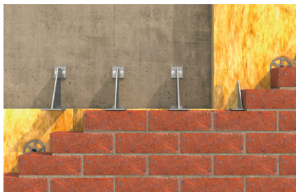
Dämmstoffe in zweischaligen Aussenwänden
